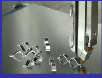
リボンボンディング (幅: 2mm, 厚み0.2mm)
