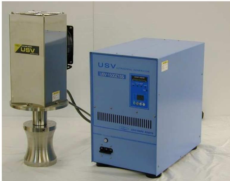
ホーン型超音波洗浄機とは、強力なキャビテーションを発生させて、細かい隙間や貫通穴、凹穴の落ちにくい汚れを粉碎、剥離して洗浄する洗浄機です。
