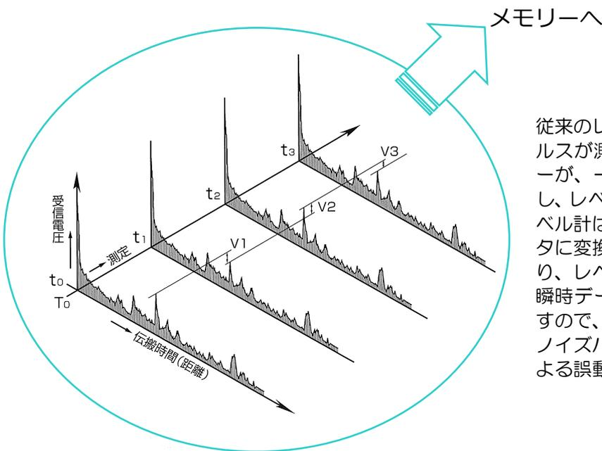
従来のレベル計では、センサから放射された超音波パルスが測定面で反射してセンサに得られる受信エコーが、一定の電圧しきい値を超える時間を直接検出し、レベル位置と判断しています。これに対して本レベル計は、受信エコー全体の振幅強度をデジタルデータに変換し、受信波判別アルゴリズムと統計処理により、レベル位置を判断します。瞬時データのみで判断せず過去のデータも参照しますので、より確度の高い測定が可能になります。また、ノイズパターンも合わせて判断しますので、ノイズによる誤動作を防ぐことができます。
