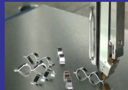
リボンボンディング (幅: 2mm, 厚み0.2mm)
