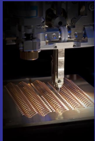
銅ワイヤボンディング (Φ200~500μm)
